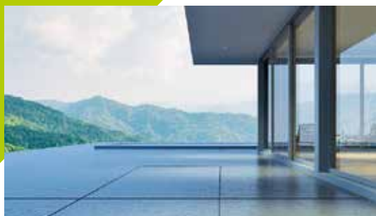
Keramické kameninové dlaždice v provedení formátu 100 x 100 cm se instalují jako obklady balkonů a teras.
