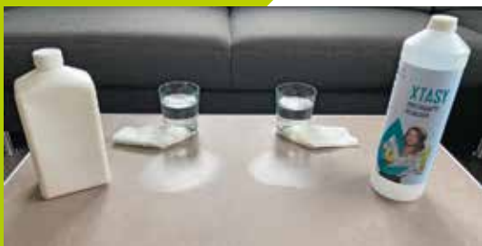
Kuchyňská utěrka se napustí čisticím prostředkem a zatíží se sklem
