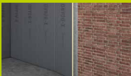
instalace dlouhých nebo krátkých desek codex X-Board na nerovný podklad pružnou tenkovrstvou maltou codex (S1)..
