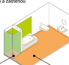
W2 cementový potěr W2 cementový potěr*
