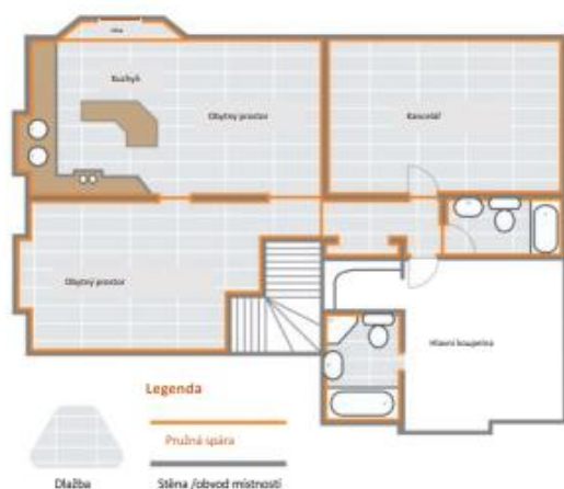
Obrázek: Schématické příklady správné praxe, kde má být dilatační pružná spára (zdroj TTA.org.uk)
