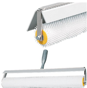
Kryt na odvzdušňovací váleček zabraňuje potřísnění stěn při odvzdušňování mokrého materiálu.
