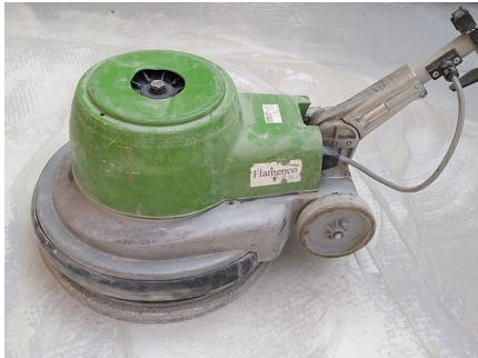
Broušení vyzrálého litého potěru
